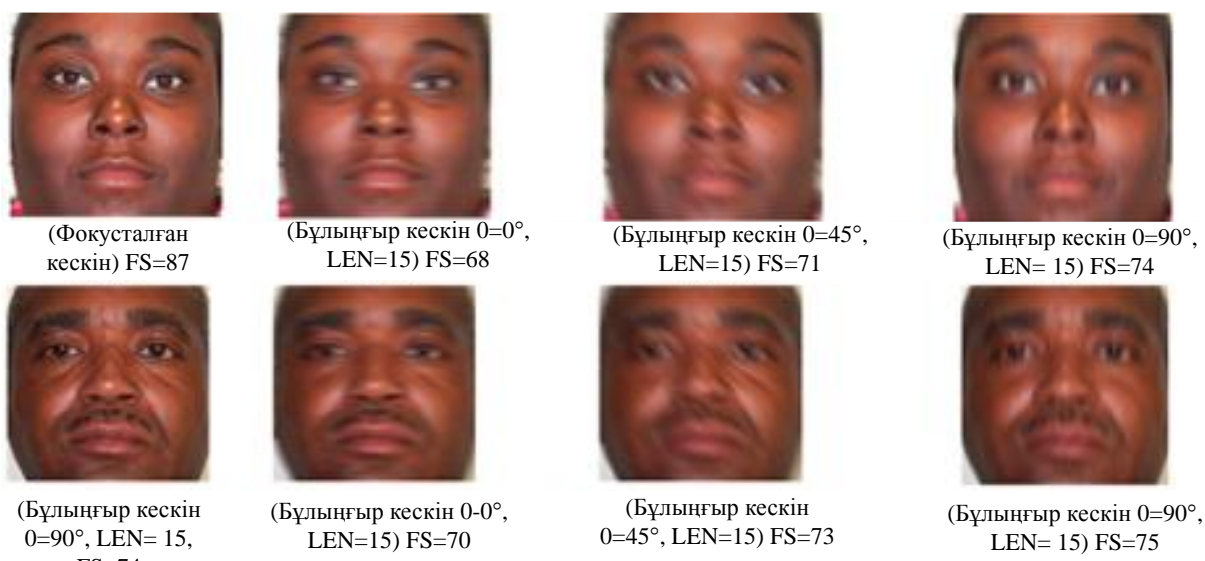
2.11 - сурет – Фокусталған кескінмен және сәйкес қозғалыс бұлдыр кескіндерімен әдісімізді қолданатын фокус ұпайын өлшеу мысалы ( \theta - қозғалыс бағыты; LEN - қозғалыс бұлыңғырлығының мөлшері (ұзындығы))
